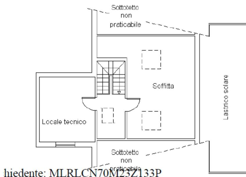
Il primo piano mansardato presenta un'altezza interna media variabile di 2 metri. Esso ospita un locale tecnico, una ampia soffitta e un lastrico solare, il tutto privi di rifiniture interne, come meglio descritto nel seguito, compreso il terrazzino.
